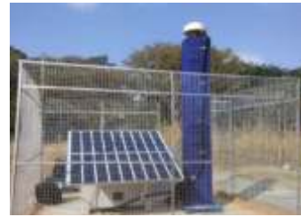
CORS स्टेशन सेटअप
